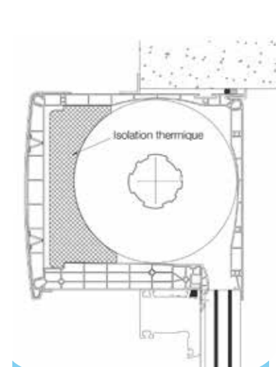
Pose en tunnel
